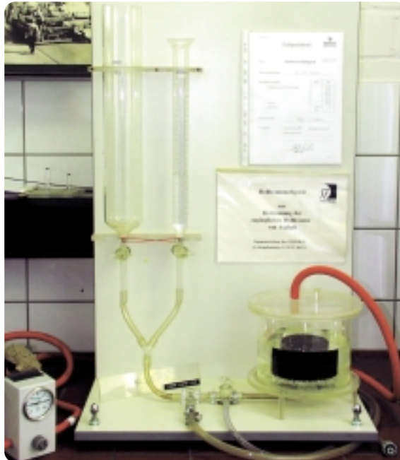
Bestimmung der zugänglichen Hohlräume mit dem Hohlraummessgerät (TEERBAU-Entwicklung)
